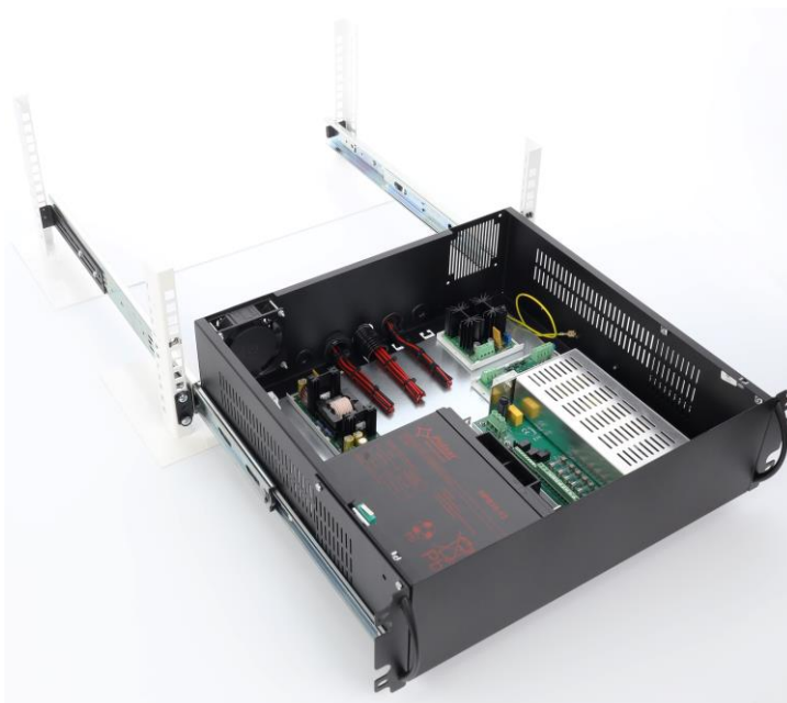
Wsuń obudowę z prowadnicami w szyny zamontowane w szafie RACK 19"
