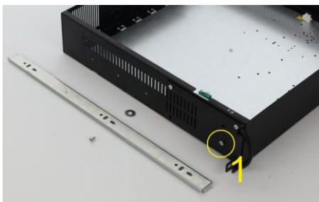
Odkręć pierwszą śrubę M4 z obudowy ARAD
